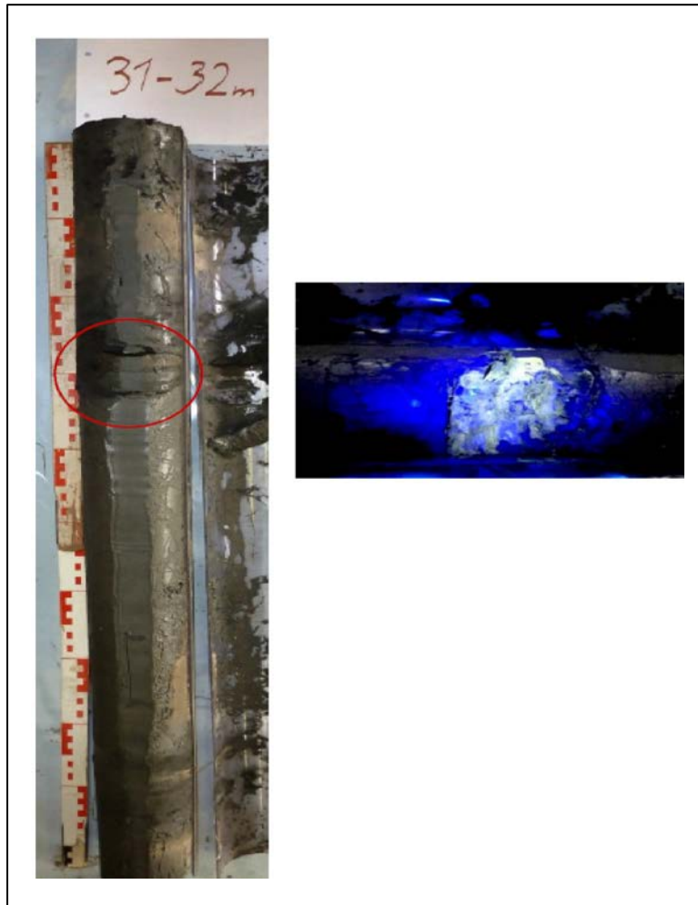
Abb. 19: Bohrkern KB1 im Bereich 31-32 m unter GOK mit Ölführung (roter Kreis und fluoreszierender Bereich), (von der Stein, 2014a).
